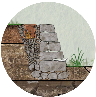
Mur en pierres sèches et cavités
